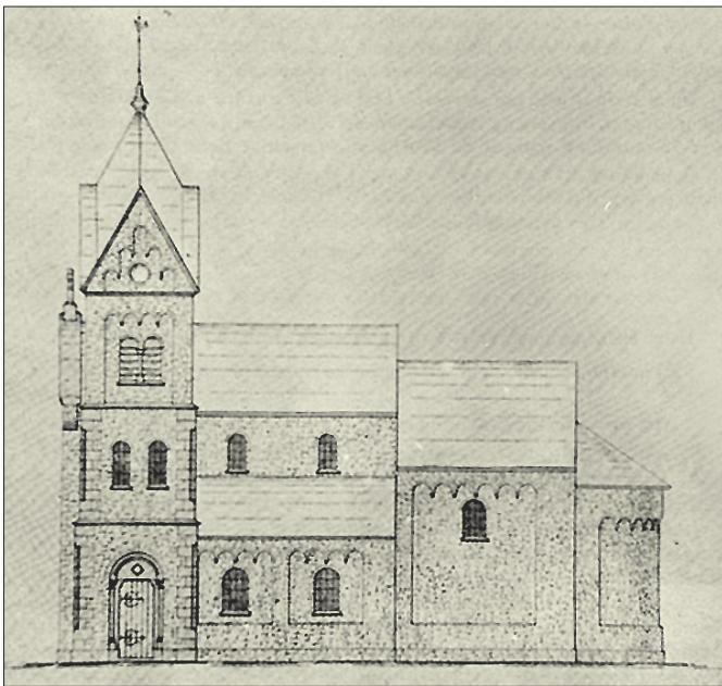
Vieuxville - Vue latérale - Projet dressé par l'architecte Plénus. On distingue très bien, à droite du dessin, le chœur et l'abside, seuls vestiges encore debout aujourd'hui. On remarquera que, dans le projet de restauration, l'architecte a pourvu les bas-côtés de bandes lombardes, reprenant en quelque sorte le patron de l'abside et du chœur. Les murs de la nef, qui étaient encore debout à cette époque, en sont dépourvus (comme à Saint-Barthélemy à Liège). Sur la tour, on remarque le chaînage au rez-de-chaussée et au premier étage, dont le C.R.M.S. demandait la suppression. Le toit du clocher est d'inspiration rhéno-mosane. Notons enfin que le tympan n'a absolument rien de commun avec l'actuel.
