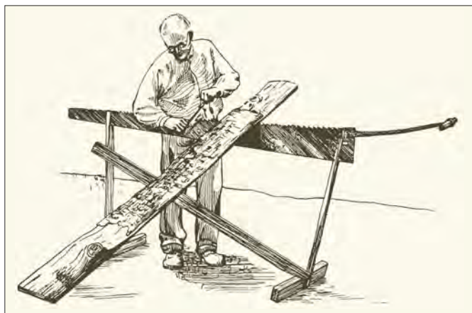
La préparation de la scie calée dans les rainures du lîmêl .
