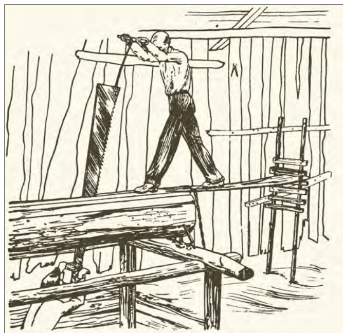
Le scieur du haut est passé sur l'allonge.
