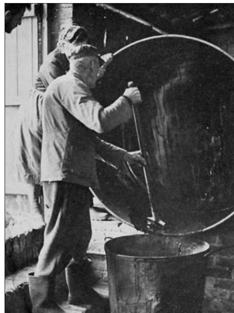
La chaudière est vidée soigneusement avec la "palète".
