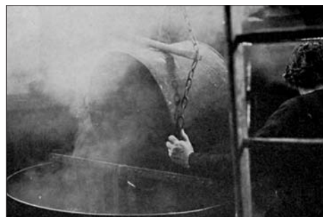
Le sirop est versé de la petite cuve dans le refroidisseur.
